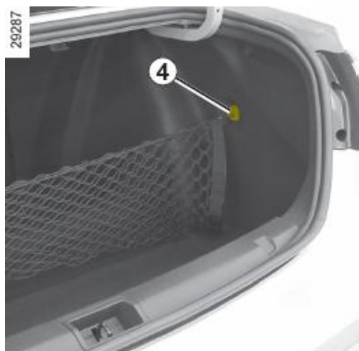
توری نگهدارنده بار در صندوق عقب (نوع ۴ درب) قلابهای 4 در دو قسمت داخل صندوق عقب برای نصب توری نگهدارنده در صندوق به کار می رود.
