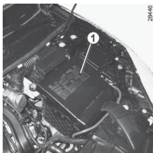
باتری 1 نیاز به هیچگونه سرویسی ندارد.
