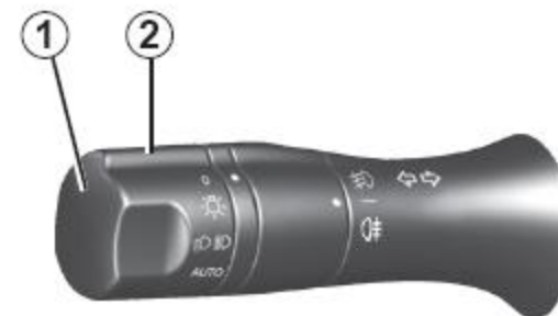
سیستم تنظیم اتوماتیک نور با تغییر جهت خودرو (بسته به نوع خودرو)
