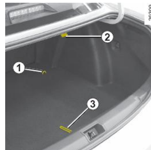
قلابهای کف صندوق قلاب 1 که در گوشه های صندوق وجود دارند، کمک می کنند تا اجسام در جای خود ساکن مانده و حرکت نکنند. بسته به نوع خودرو، جهت دسترسی به چرخ زاپاس، کف پوش صندوق عقب را، با استفاده از تسمه 3 و بستن آن به قلاب 2 بلند کنید.
